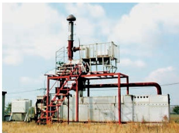
写真 試作した連続式炭化炉
